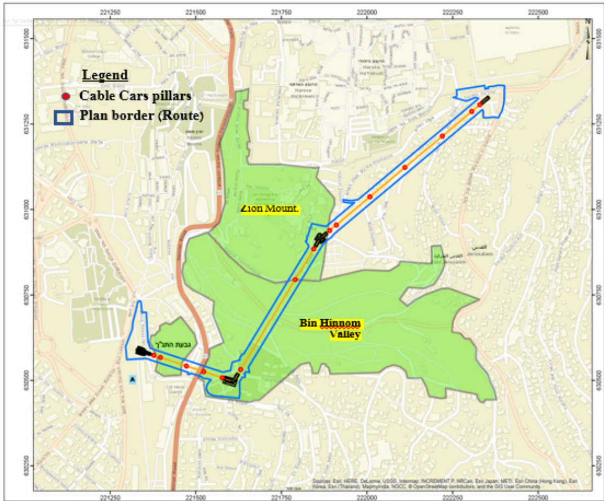
شكل رقم 7: الأماكن التي ستبنى فيها الأعمدة التي تسند كابلات التلفريك
